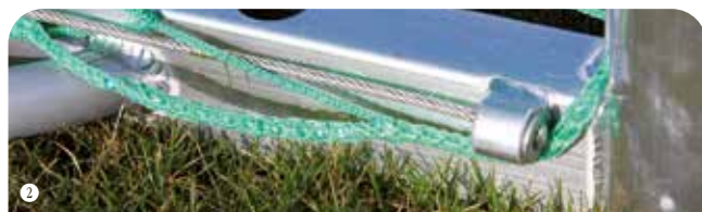
Stahlseil zur Netzsicherung
