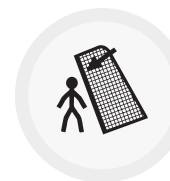
NACH DIN-EN 15312 Freistehende Tore sind gegen Umkippen zu sichern!
