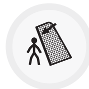
NACH DIN 16579 Freistehende Tore sind gegen Umkippen zu sichern!
