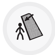
NACH DIN EN-15312 Freistehende Tore sind gegen Umkippen zu sichern!
